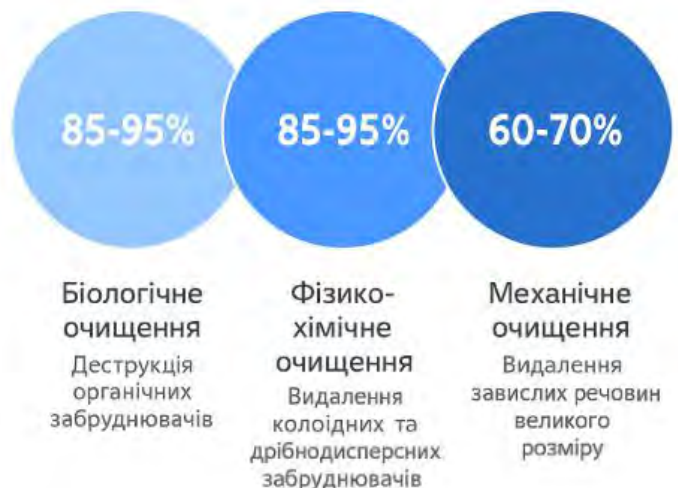
Рис. 2. Основні стадії очищення стічних вод целюлозно-паперових підприємств та їх ефективність
